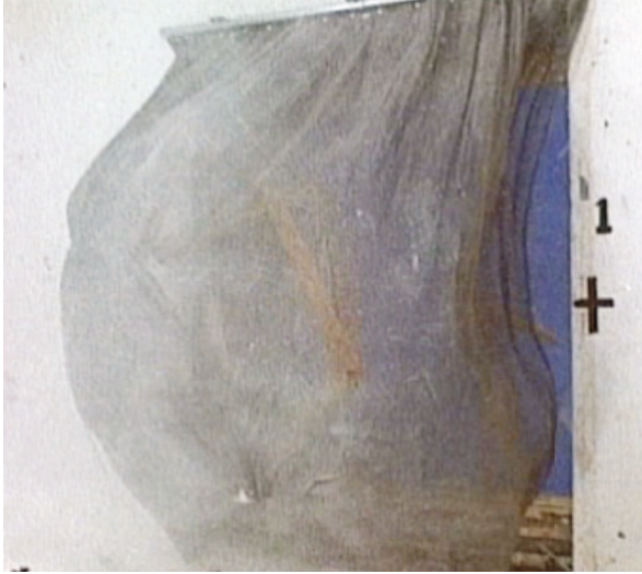
ARA Live Blast Test 1/4"-19ga. Steel
